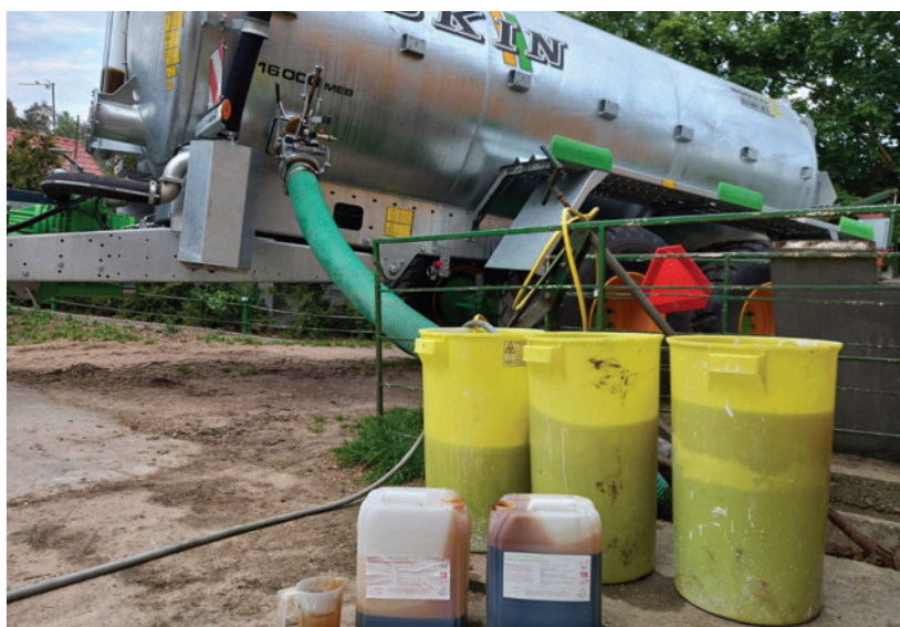
Fot. 5. Jednym z najczęściej pracujących w gospodarstwie urządzeniem jest wóz asenizacyjny Modulo 2 JOSKIN o samonośnej konstrukcji z podwójną osią i pojemnością 16 000 l, który w jednym przejeździe aplikuje gnojowicę w formie płynnego humusu z produktem do tlenowej aktywacji gleby
